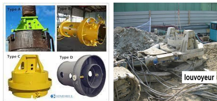
Figure 1.38 : Outils de forage adapté pour différents horizons-foré simple. [17]
