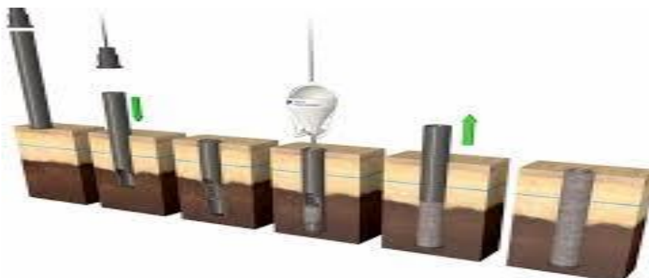
Figure 1.17 : Pieu battu moulé. [12]
