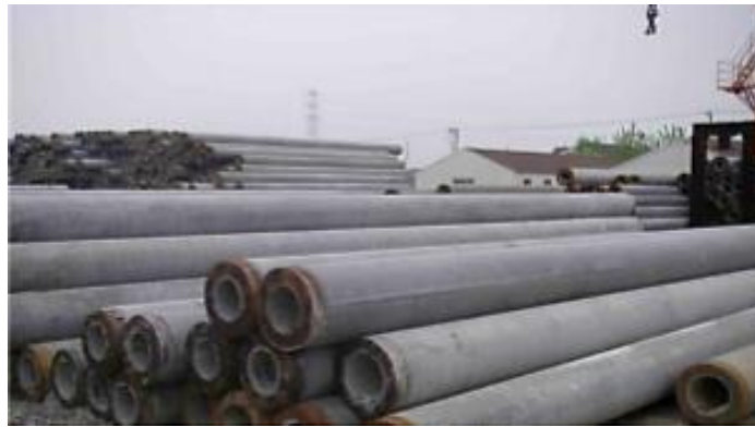
Figure 1.11 : Pieux en béton. [11]
