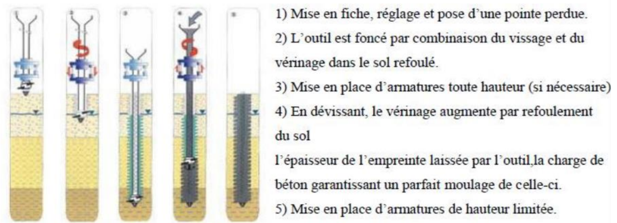
Figure 1.30 : Pieu vissé moulé. [15]
