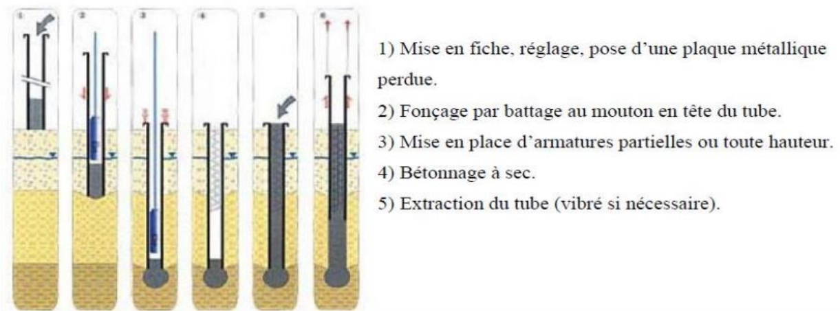
Figure 1.29 : Pieu battu moulé. [16]
