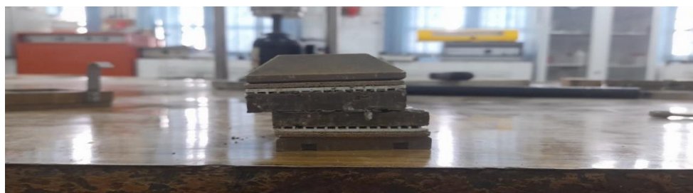
Figure 42 : un échantillon après cisaillement.
