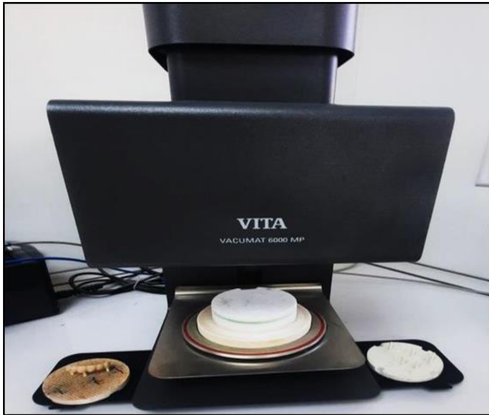
Figure II .15 : Glassage chimique de la zircone dentaire par traitement thermique au four
