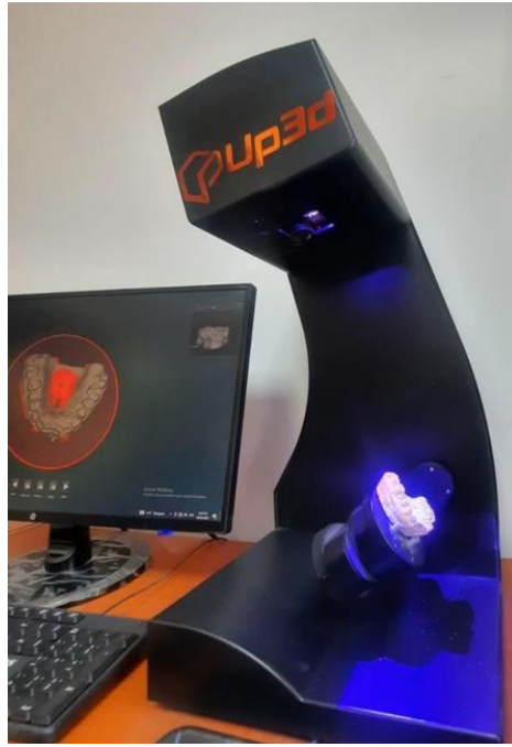
Figure II .8 : Prise d'empreintes dentaires à l'aide d'un scanner intra-oral ou d'un scanner 3D
