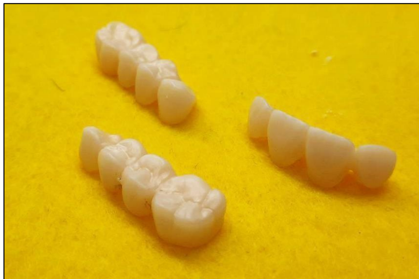
Figure III. 12: Échantillon zircone après le traitement thermique
