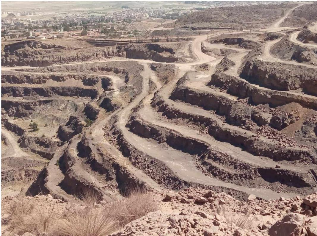
**Figure III.2:** L'ouverture par demi-tranchée d'accès dans la mine d'Ouenza.
