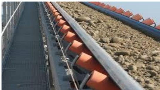
**Figure I.7 :** convoyeur à bande
