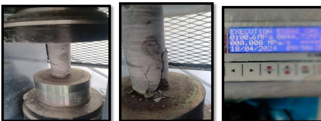
Figure III.36 Eprouvette de Calcaire (cylindrique)
