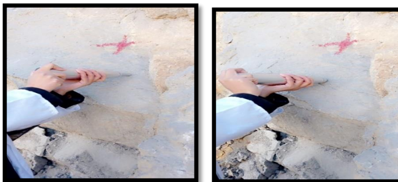
Figure III.31 Mesure la résistance par scléromètre.
