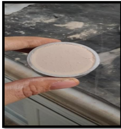
Figure III.19 Retirage de la pastille, nettoyage de la surface de pastille.
