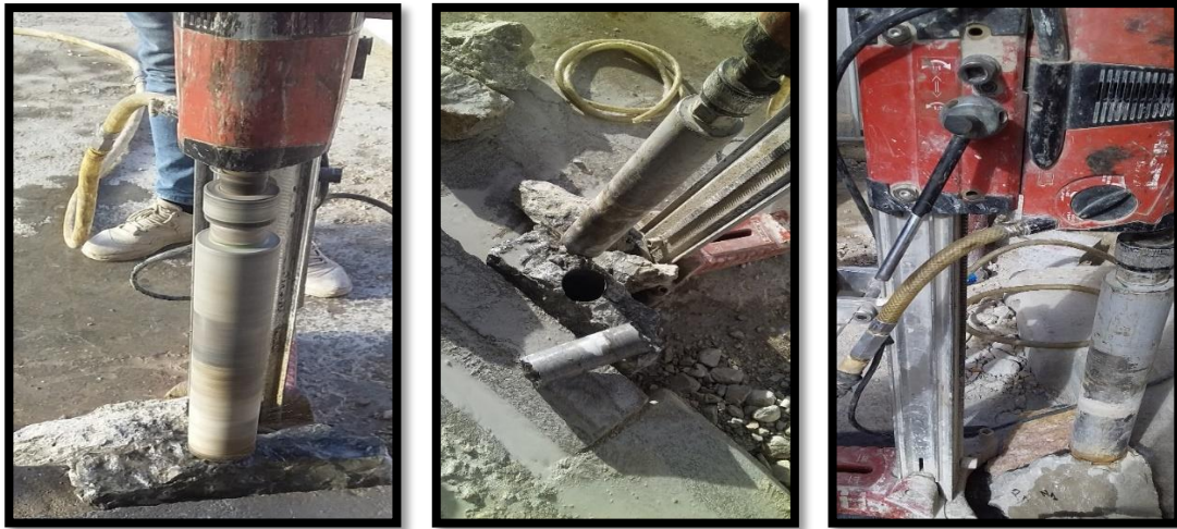
Figure III.34 Préparation des échantillonnages en utilisant la carotteuse.
