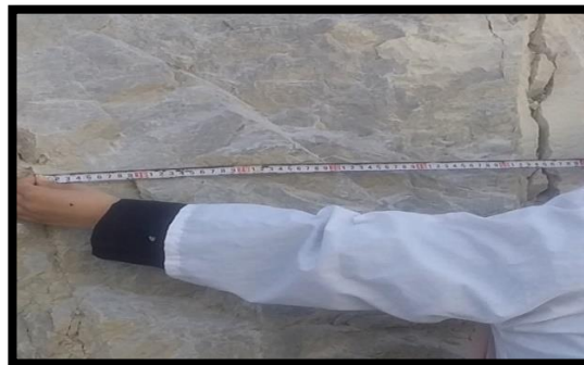
Figure IV.3 Photos de la mesure RQD de calcaire
