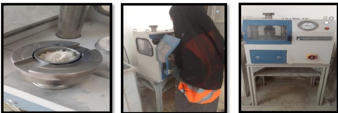
Figure III.18 L'emplacement de la pastille dans la pastilleuse et recouverte de matière broyée.
