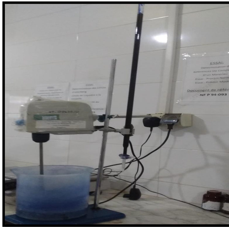
Figure III. 22 Essai au bleu de méthylène
