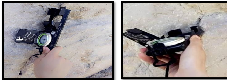
Figure VI. 4 Mesure de l'orientation de discontinuités (pendage et direction pendage)
