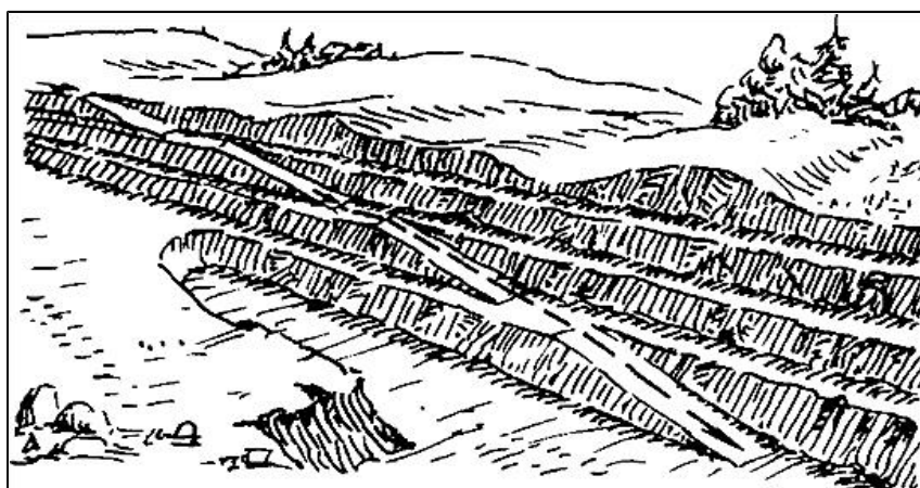
FigureIV.7:Aspect du bord de la mine à ciel ouvert en découverte par un système de tranchées intérieures consécutives[9]
