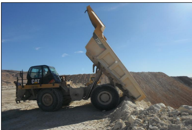
Figure II.20 : La mise à terril de stérile dans la carrière de Djebel Onk
