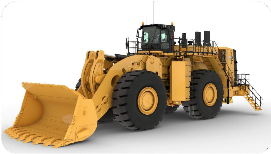
FigureIV.18: chargeuse sur pneu de type Caterpillar995[24]
