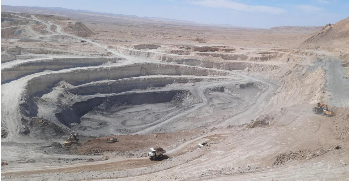
Figure II.8: Méthode d'exploitation avec transport par camions.
