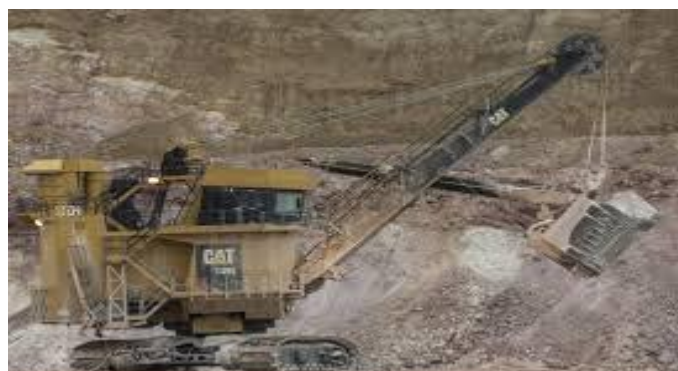
Figure I.7 : pelle à câble sur chenille.
