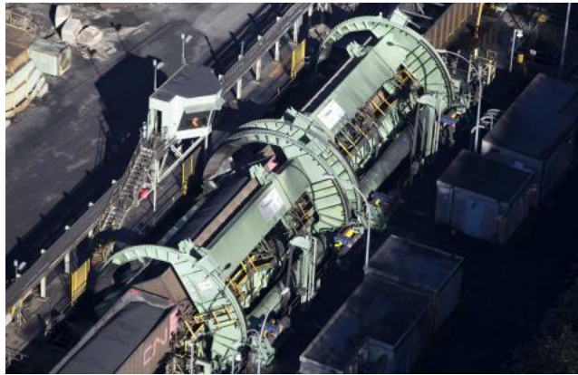
Figure V.4: culbuteur à dispositif rotatif de déchargement en tandem. [29]
