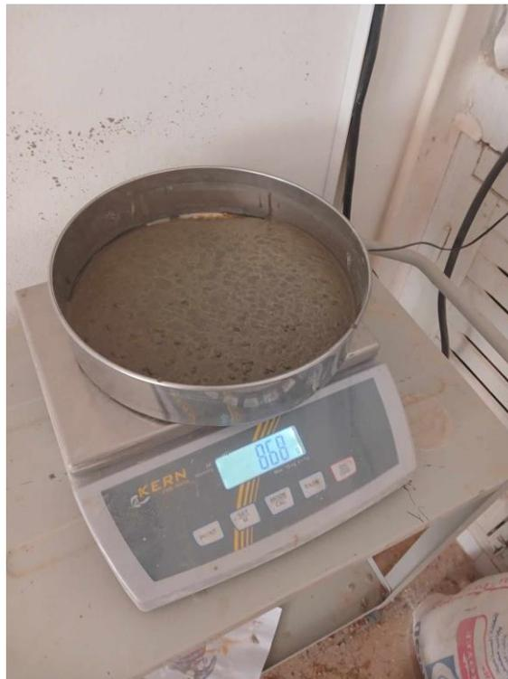
Figure 3.3 : Essai de stabilité au tamis
