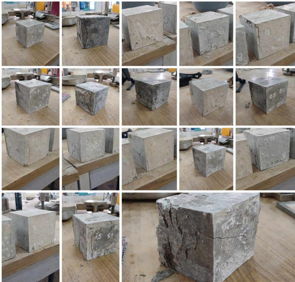
Figure 3.24 : Les ruptures dans les éprouvettes
