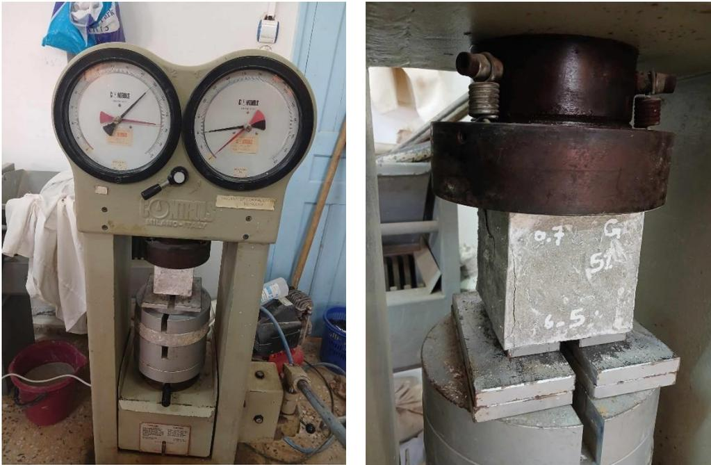
Figure 3.22 : Essai d'écrasement machine manuelle
