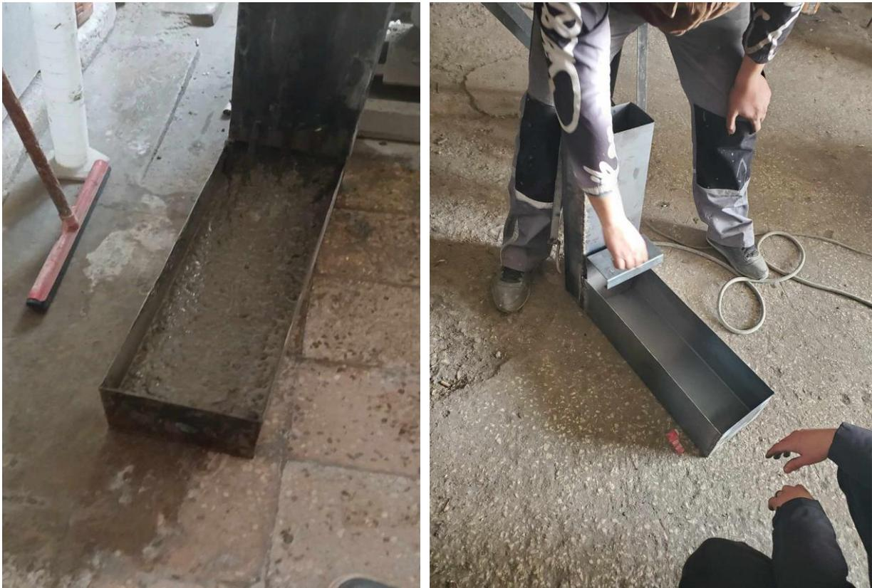
*Figure 3.4 : Essai de boîte L*
