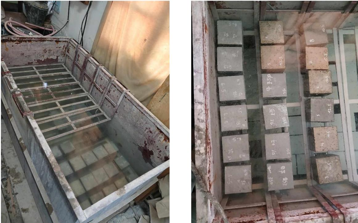
Figure 3.6 : Les éprouvettes conservées sous l'eau
