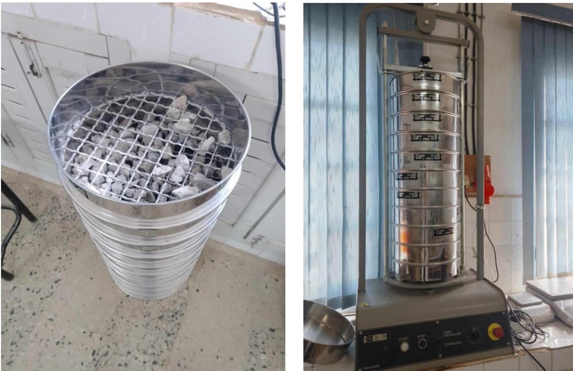
Figure 2.6 : Essai de tamisage des granulates
