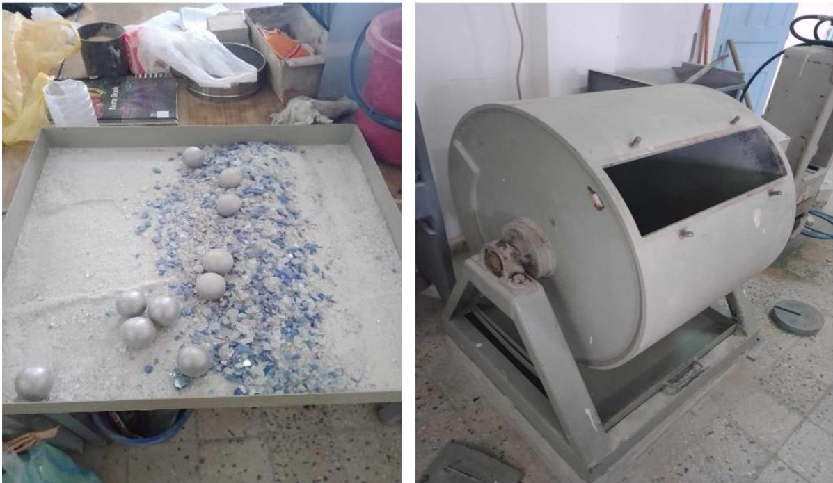
*Figure 2.5 : Machine los Angeles ( operation de concassage du verre)*
