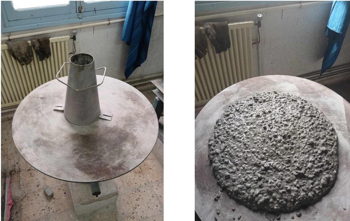
Figure 3.2 : Essai d'étalement au cône d'Abrams
