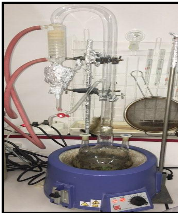
Figure 19 : Montage d'hydrodistillateur type Clevenger (photo personnelle).
