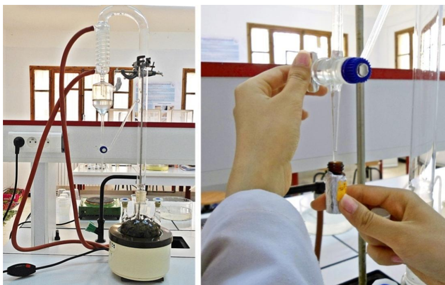
Figure 24 : Montage de l'hydrodistillateur de type Clevenger (BOUGUERRA., 2019).
