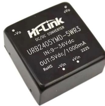
Figure III. 6 Convertisseur DC-DC, entrée large 9-36V, sortie 5W, 5V et 1A.
