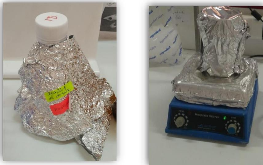
**Fig. 32 : Préparation du réactif de BRADFORD**
