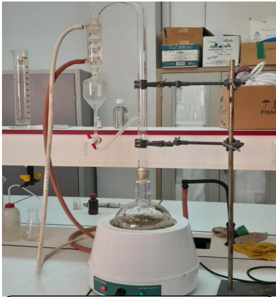
Figure 13. appareil hydrodistilateur (photo personnelle)
