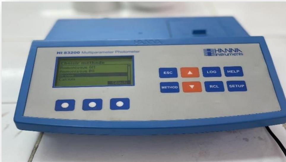
Figure 6 : Multi-paramètres Photometer HI 83200 (HANNA instruments)
