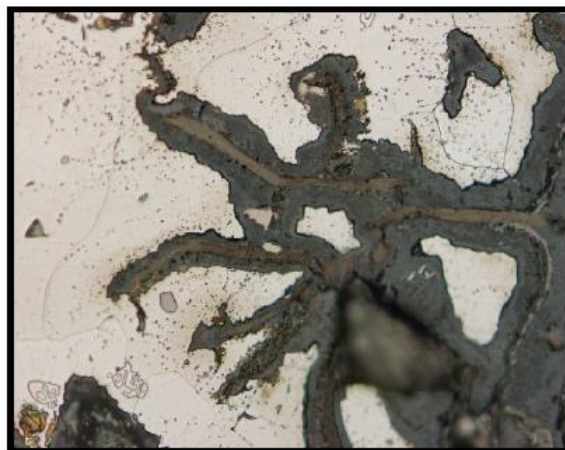
Figure I. 9 : Photographie métallographique illustrant la corrosion sélective d'un laiton.
