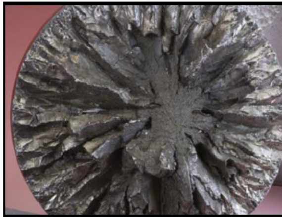
Figure I. 8 : Corrosion inter-granulaire d'un acier inoxydable.
