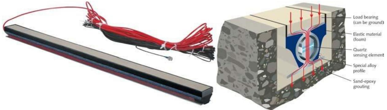
FIGURE 2.4 – Capteur de trafic piézo-électrique à quartz (capteur Linesas de chez Kistler)
