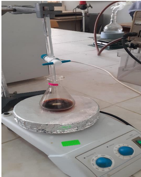
Figure IV.10 : Détermination de l'indice d'iode par titrage avec la solution de thiosulfate de sodium.
