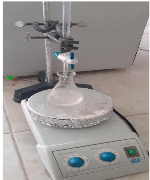
Figure IV.10 : Détermination de l'indice d'iode par titrage avec la solution de thiosulfate de sodium.
