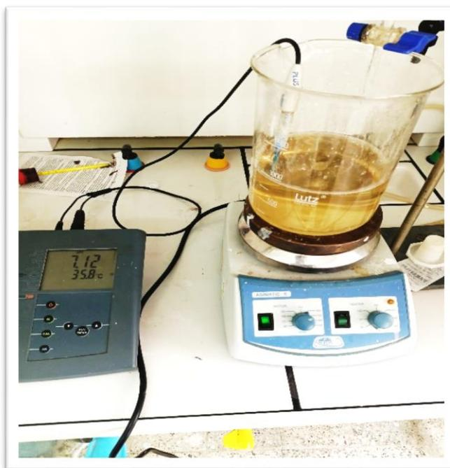
**Figure II.3.5.1** Dispositif de neutralisation
