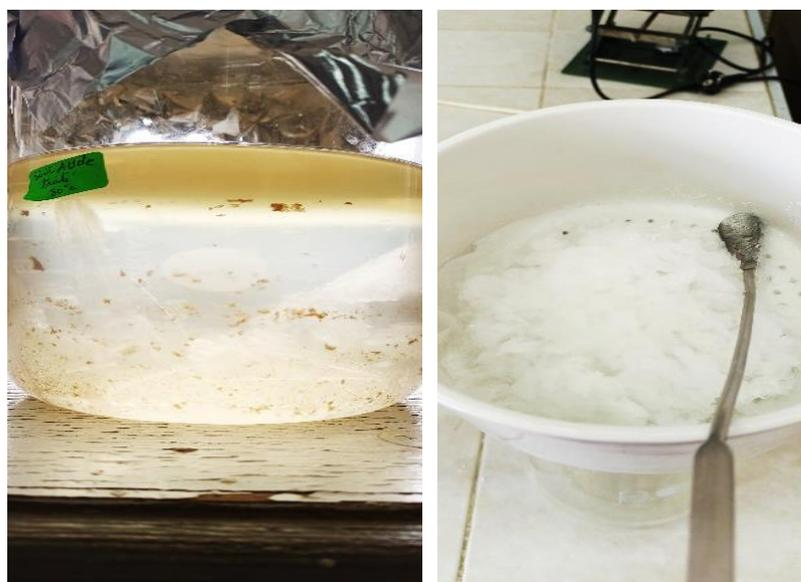
**Figure II.3.5.2** Les cristaux avant et après la filtration sous vide
