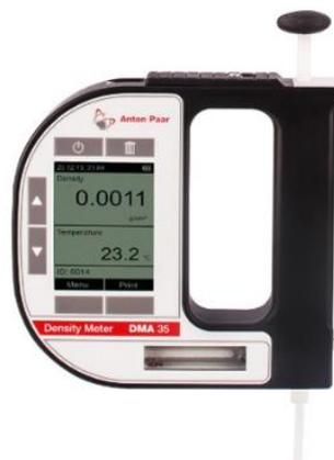
**Figure II.3.1.1** Densimètre électronique
