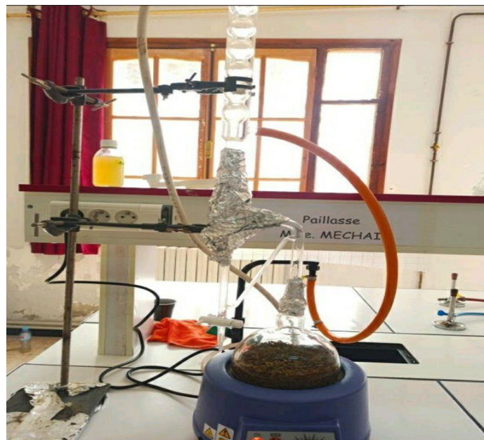
Figure 06 : Dispositif de l'hydrodistillation de type Clevenger.
