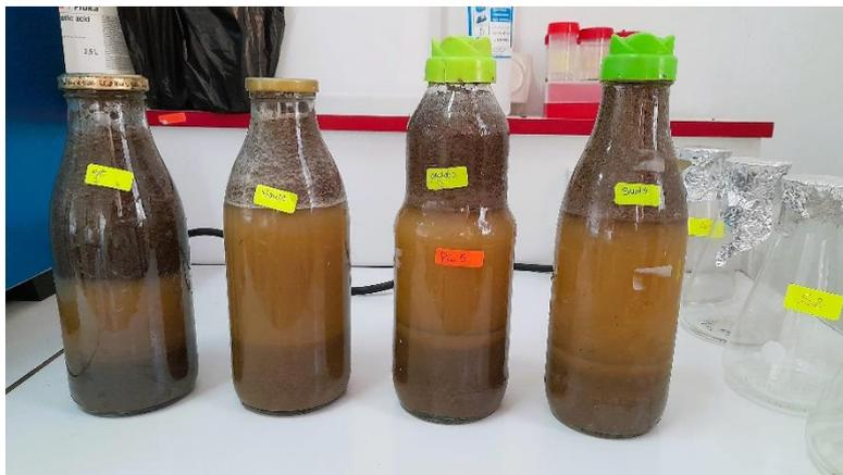
**Figure 15** : La granulométrie par le test de la bouteille
