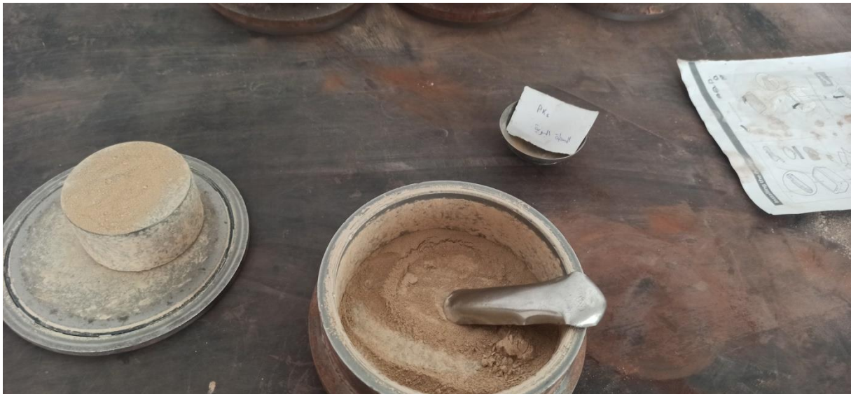
Figure 27: échantillon après l'opération de broyée (forme de poudre très fin)
