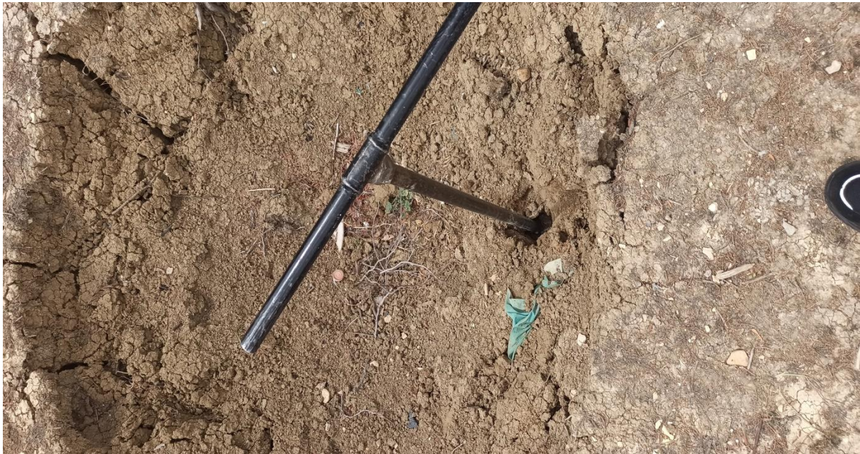
Figure 12: Tarière edelman pour prendre un échantillon
