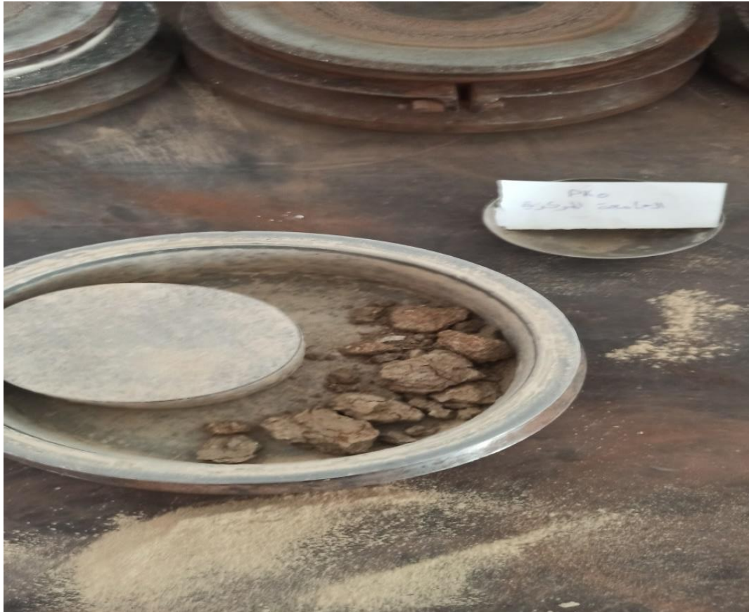
Figure 25: échantillon dans le moule de broyeur
