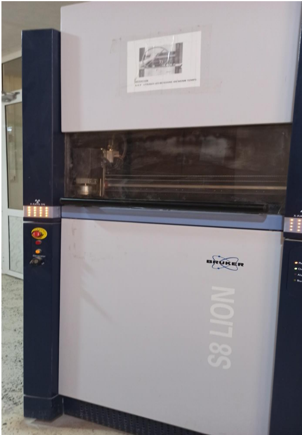
Figure 31: Insertion d'échantillons dans l'appareil à FRX
