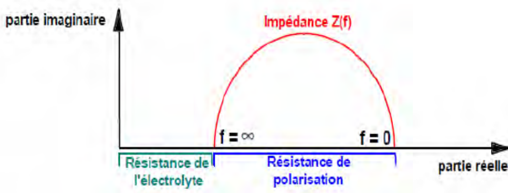
Figure III.5. Représentation schématique d'un diagramme d'impédance de Nyquist d'un système électrochimique ( f : fréquence) [5]
