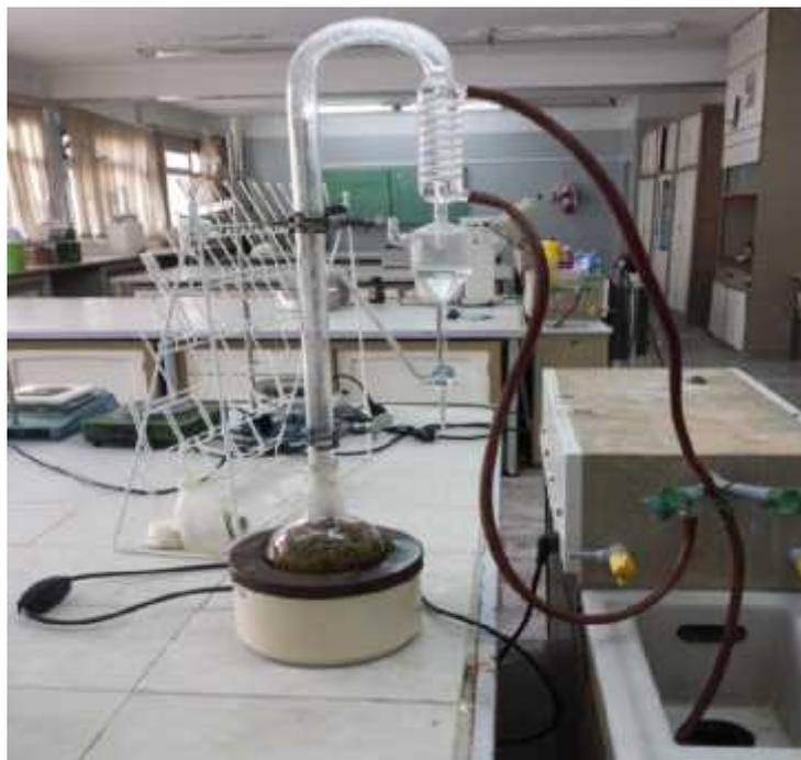
**Figure 21 :** Montage d'hydrodistillation
