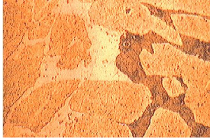
Figure- I. 4 corrosion sélective
