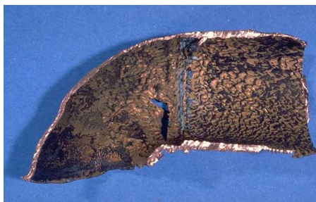
Figure- I. 6 corrosion érosion
