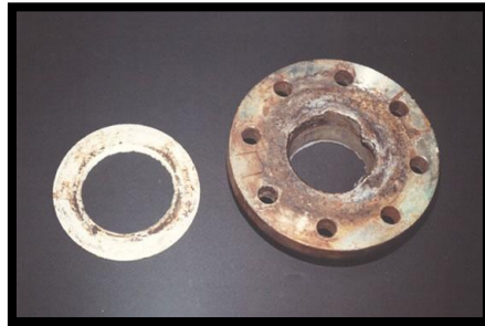
Figure- I. 5 corrosion caverneuse
