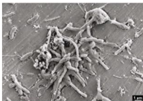
Figure-I.8 corrosion bactérienne
