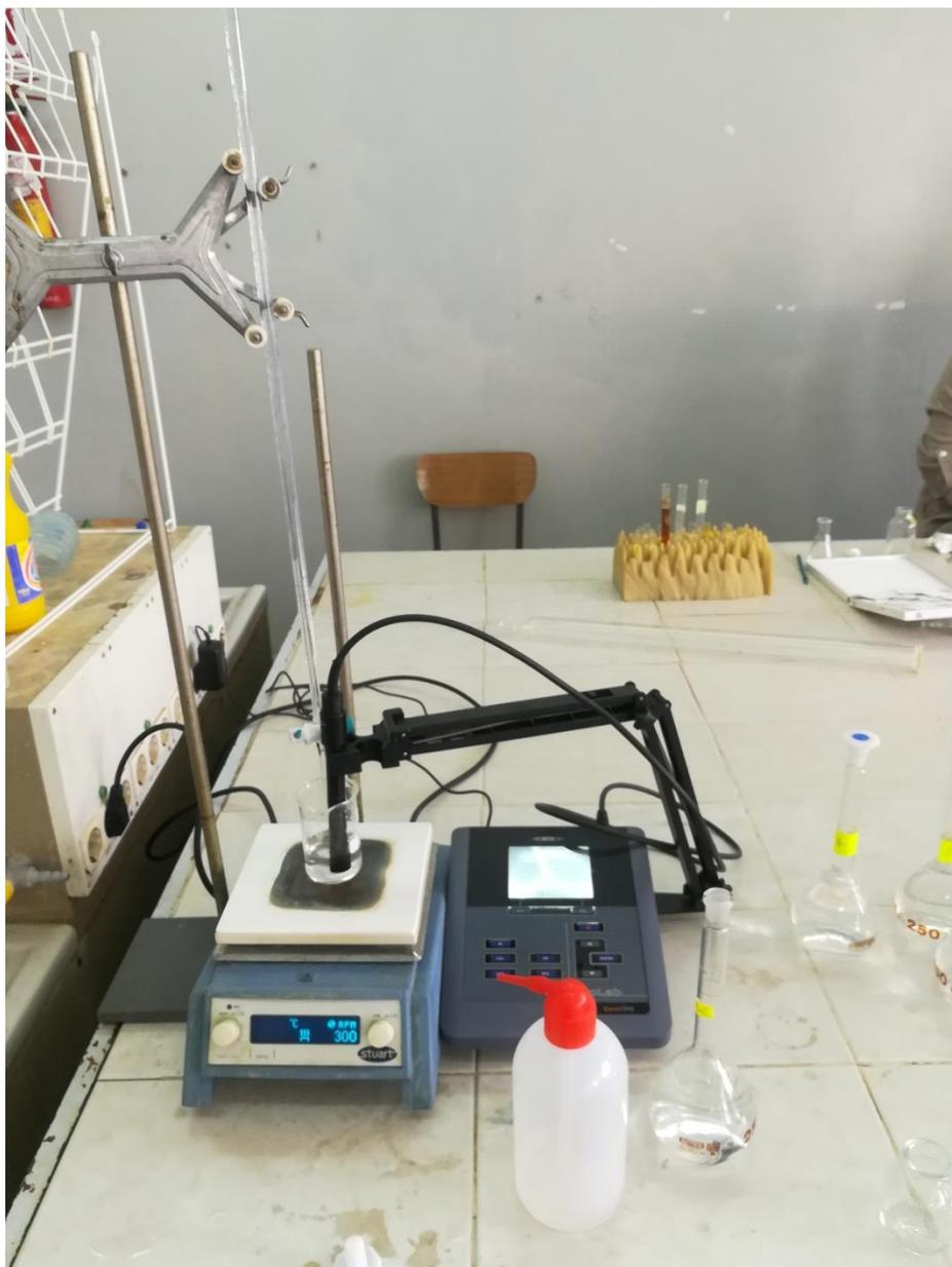
**Figure10.**montage d'un dosage conductimétrique .
