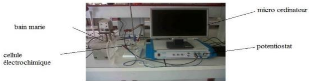
Figure II.6. photographie du dispositif de mesures électrochimiques.
