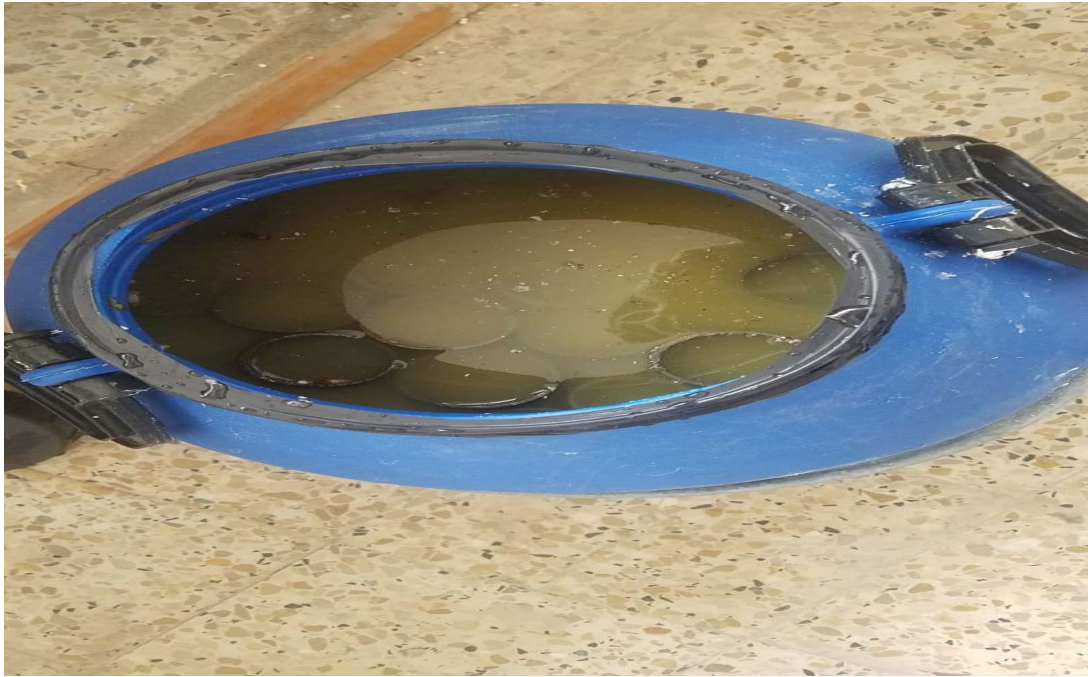
Fig III.4 : le digesteur durant son remplissage par le déchet agricole dilué.
