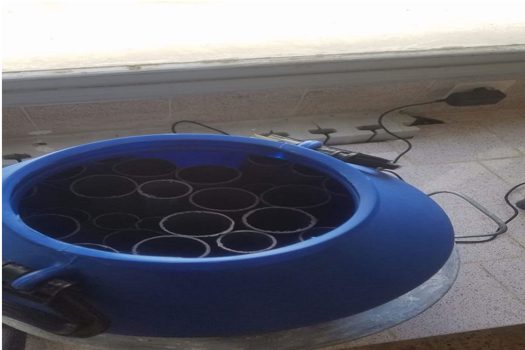
Fig III.3 : le réacteur durant la préparation et le remplissage par les PVC.
