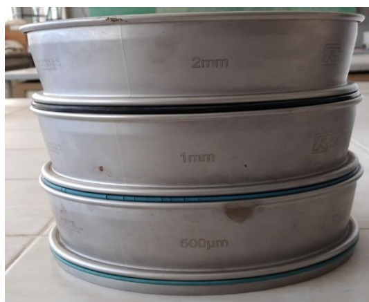
Figure A.3 : Les différents tamis selon les diamètres de pore.
