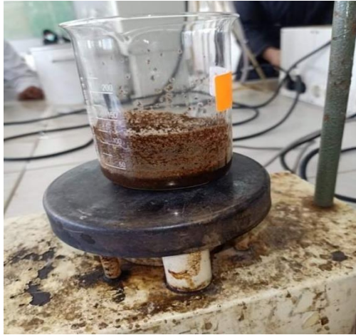
Figure A.8 : Prétraitement chimique du marc de café.
