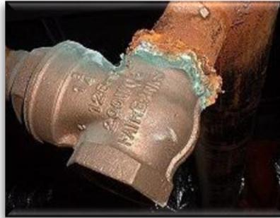
**Figure I-6 :** Corrosion galvanique résultante d'un assemblage de deux métaux différents : robinet en cuivre et conduite en acier galvanisé.
