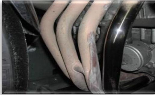
**Figure I-2 :** Mécanisme de la corrosion atmosphérique : exemple de la corrosion d'un collecteur d'échappement.
