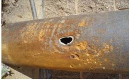
**Figure I-8** Corrosion par piqûre dans les tuyaux en acier doux.
