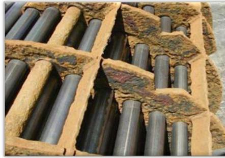
**Figure I-11:** Corrosion galvanique des chicanes en acier de l'échangeur
