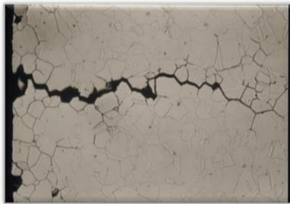
**Figure I-10:** La corrosion sous contrainte
