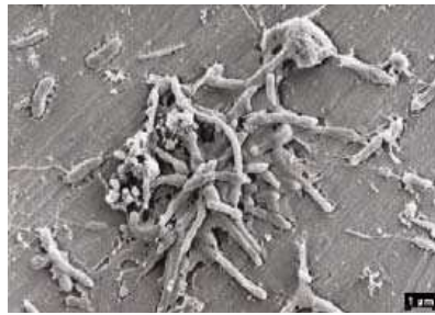
Figure 12 : Colonie de Desulfovibrio vulgaris sur acier inoxydable [5].
