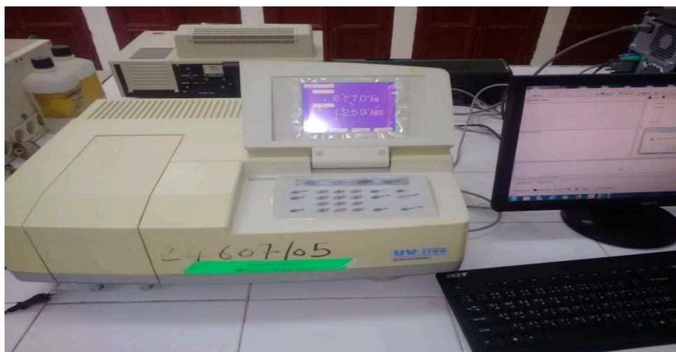
**Figure 25 :** spectrophotomètre UV-Vis
