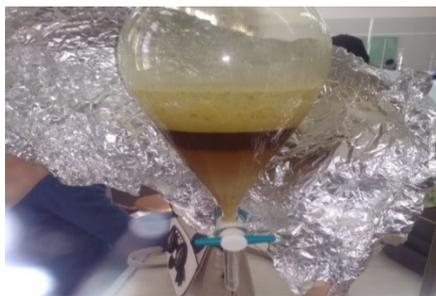
**Figure 18 :** extraction liquide-liquide par l'ether de pétrole
