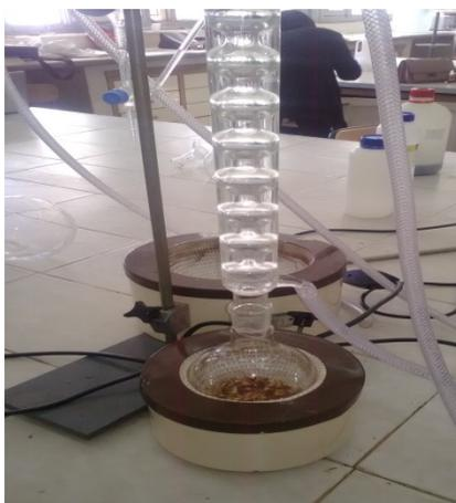
Figure 16 : montage à reflux
