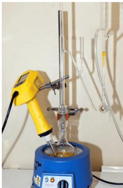
**Figure 06 :** Montage d'hydrodistillation assistée par ultrasons [42].
