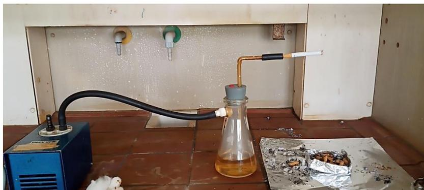
**Figure 29** : Montage du dispositif de fumage.
