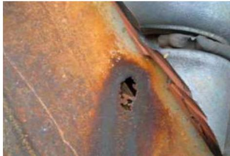
**Figure I.5:** Corrosion localisée
