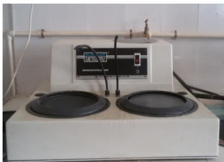
**Figure. II.4 :** Appareil de polissage (Grinder-Polishe)
