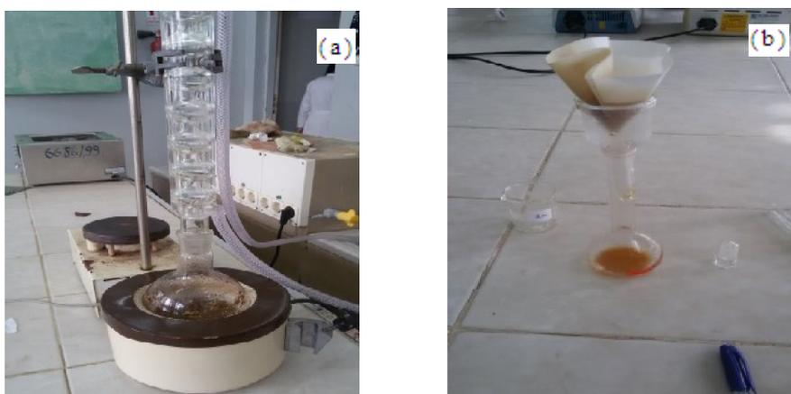
**Figure II.10:** montage à reflux de feuille d'*Ephedra major* (a) et filtration du mélange (b)
