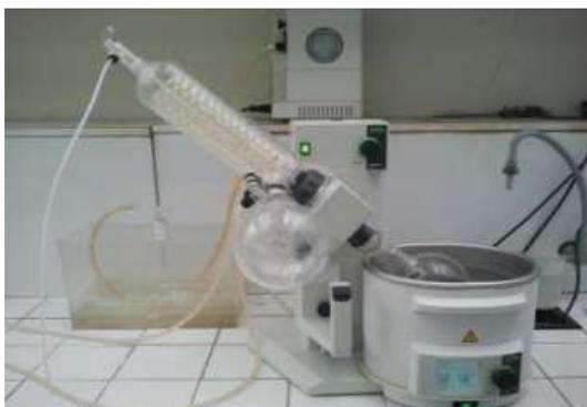
**Figure II.7:** Evaporateur rotatif
