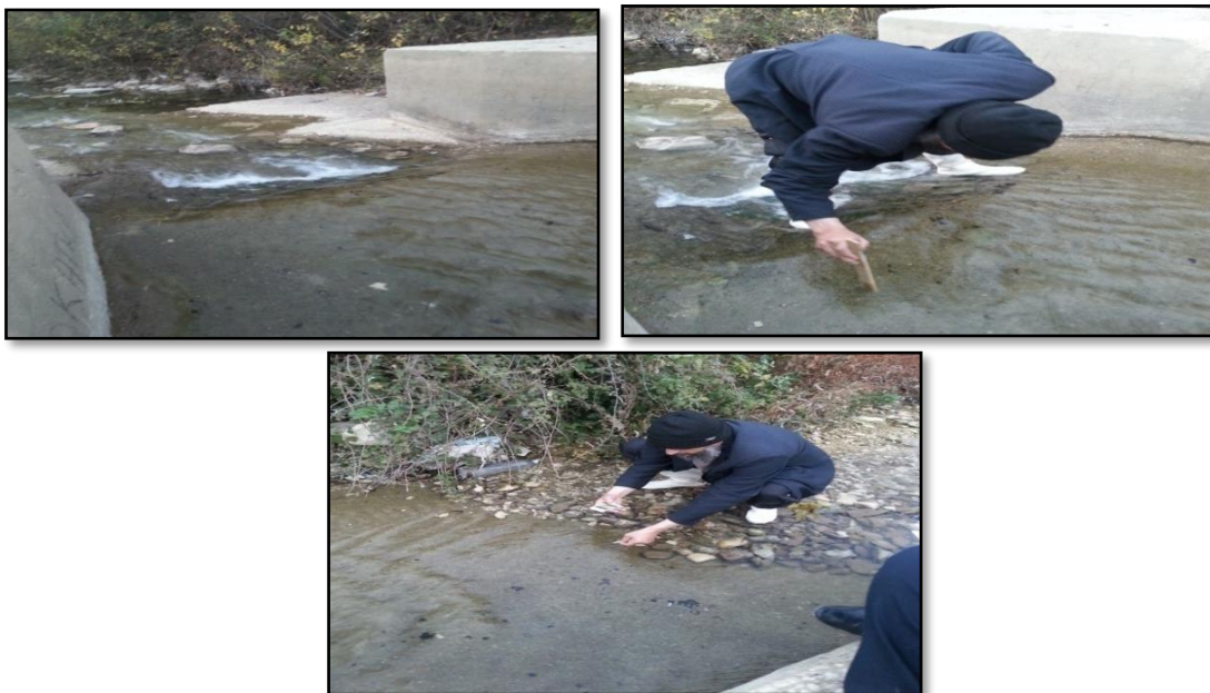
Fig.03. Jaugeage au flotteur à Oued Bouakous (13/12/2015)
