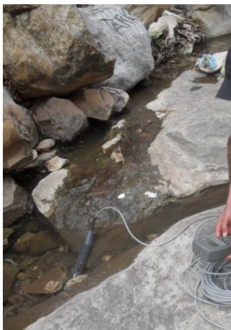
Fig. 104.a: le multi paramètre pour faire les mesures des conductivités Oued Bouakkous (grotte). (Cycle 2016). Dj Bouakkous ouest de la région d'étude
