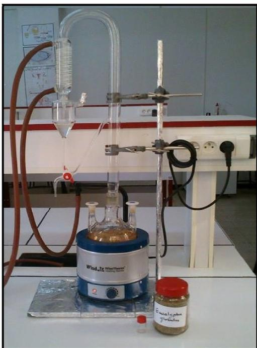
**Figure 11 :** Montage de l'hydrodistillateur de type Clevenger (DEGAICHIA et SEHAILIA., 2017).
