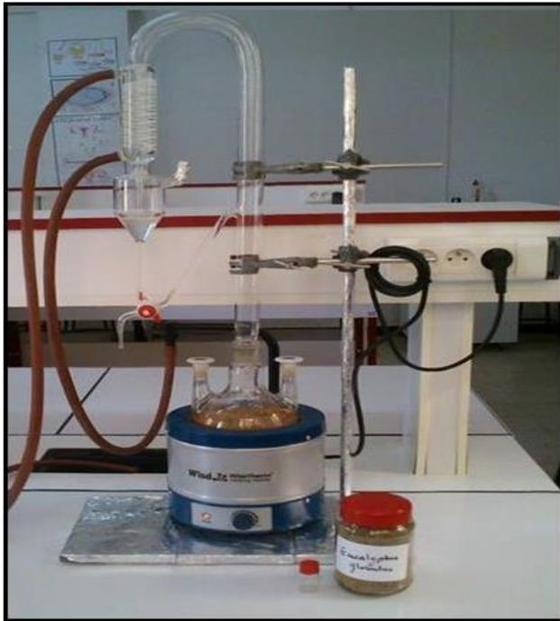
**Figure18.** Montage de l'hydrodistillateur de type Clevenger (Degaichia & Sehalia, 2017)
