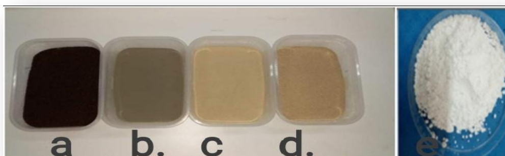
Figure25: Les constituants du sol artificiel : (a) tourbe (b) argile (c) sable fin (d) sable (e) carbonate de calcium \text{CaCO}_3 (photo personnelle ).
