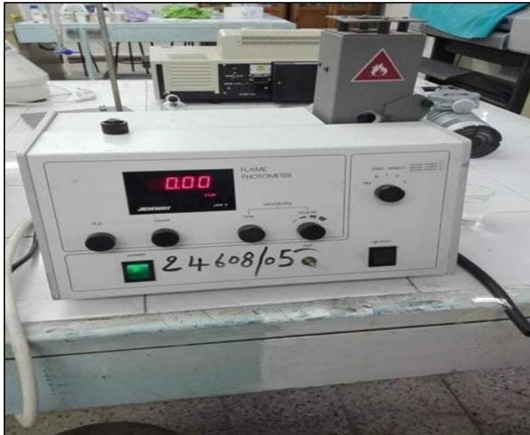
Figure 25 : Spectrophotomètre de flamme (photos personnelle 2020).
