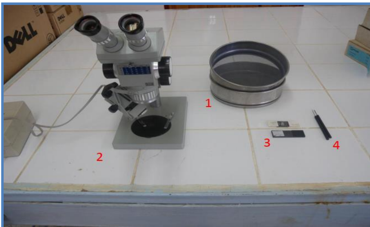
Fig.14 : Matériel nécessaire au lavage et au tri des microfossiles des roches meubles
