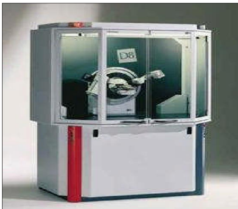
Figure 10.2 : Diffractomètre bruker d8 advance
