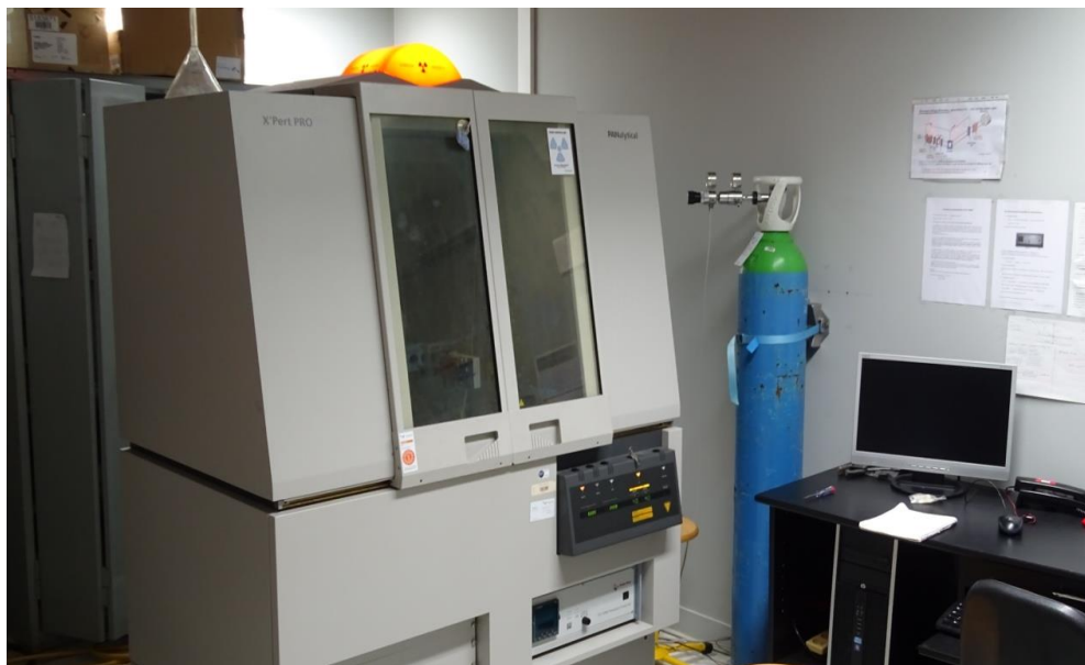
Figure 10.1 : Diffractomètre aux Rayons X de système XPERT-PRO (Laboratoire Université El Manar, Tunis). 121
