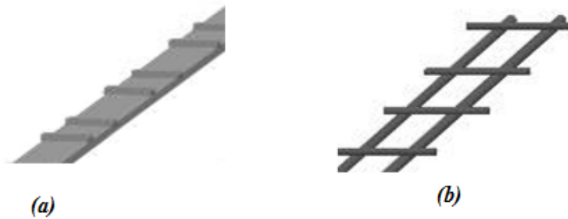
Figure 2.3. Armatures métalliques : (a) bandes métallique haute adhérence, (b) treillis soudés
