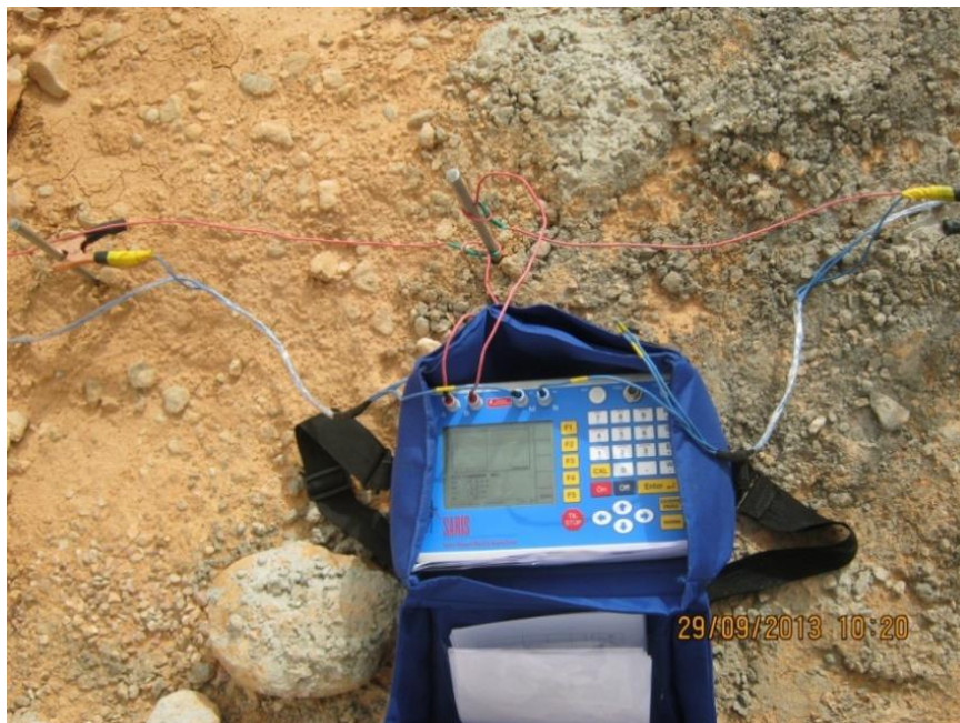
Figure 25 : Système d'imagerie électrique SARIS
