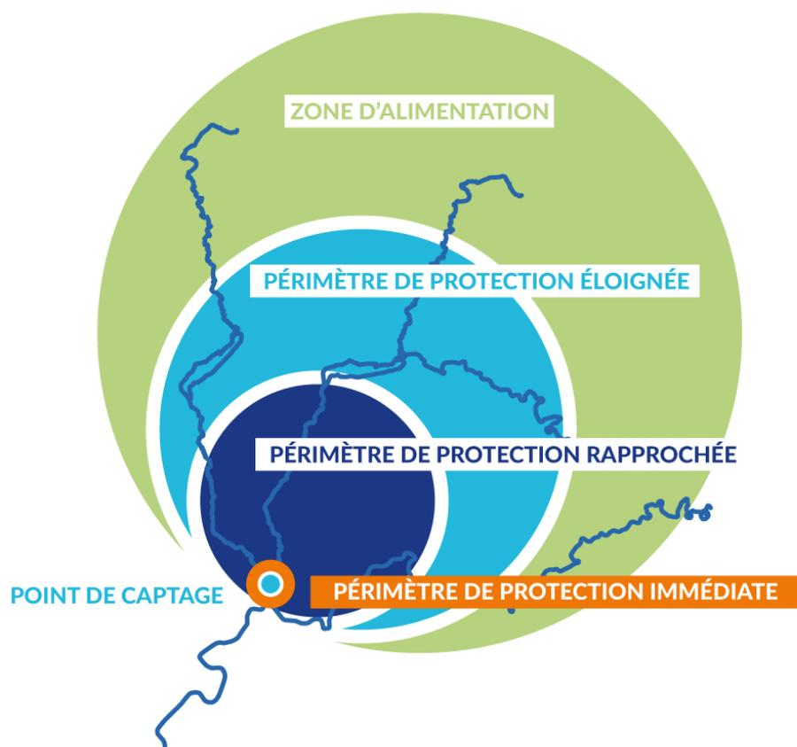
Figure 01 : Schéma représentatif des périmètres de protection (source : Google image)
