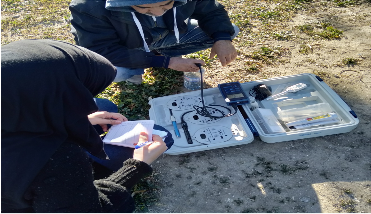
Figure 29 : mesure des paramètres physique par valise multi-paramètres.
