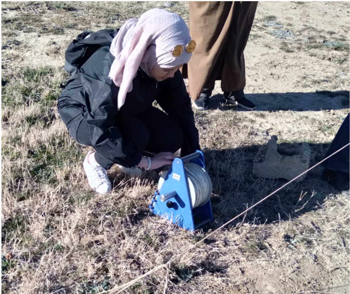
Figure 22 : Mesure de niveau piézométrique sur la plaine de Tébessa Février 2020.
