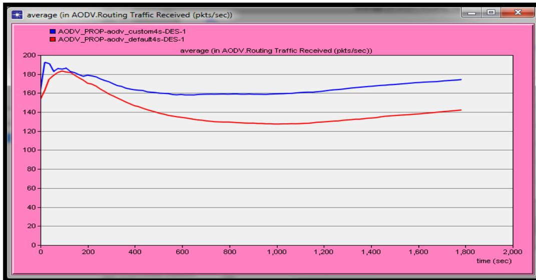
Figure 6.12: trafic reçu AODV vs AODV optimisé avec 24 nœuds.
