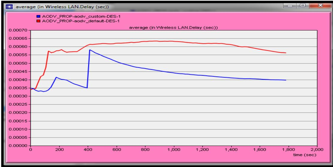
**Figure 6.13: délai AODV vs AODV optimisé avec 8 nœuds.**
