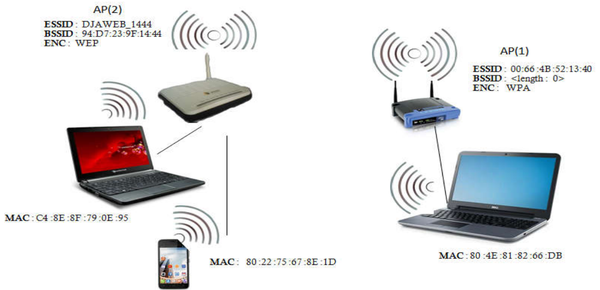
Figure N°27 : Schéma de point d'accès (1,2) et leur station
