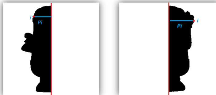
Figure [V.9] : De gauche en droite la profondeur de la ligne (i) calculée à partir de la partie gauche et droite.
