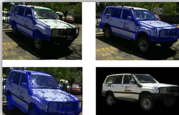
Figure [II.10] : Reconstruction semi-automatique : Exemple de détection des vertices et arrêtes pour obtenir le modèle final.
