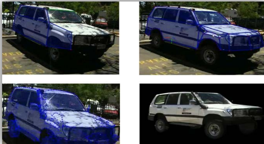
Figure [I.16] : Reconstruction semi-automatique : Exemple de détection des vertices et arrêtes pour obtenir le modèle final.
